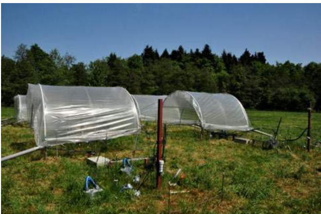
Der Versuchsaufbau auf einer Wiese, um extreme Wetterereignisse zu simulieren.
